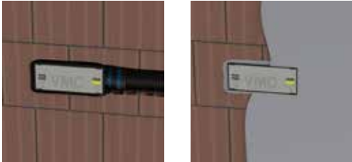
Anwendung Ziegelmauer | Brick wall application
